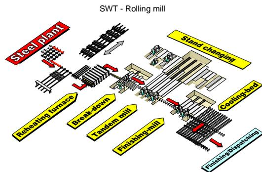
Figure 2 – Rolling mill of Stahlwerk Thüringen
